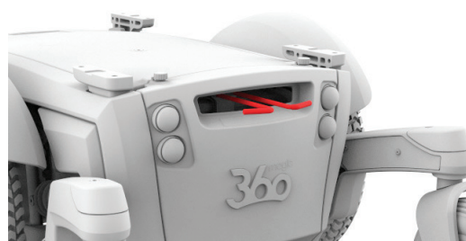
Figura 4.4b Alavancas dos travões da Magic 360 libertadas
