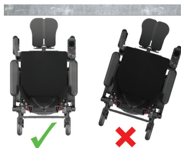
Figur 3.1 - Kjør over et trinn eller en kant
