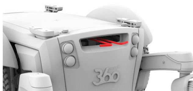
Figur 4.4b - Magic 360 bremsespaker deaktivert
