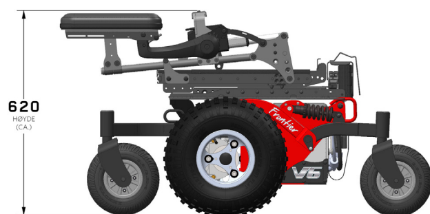
Figur 4.3c - Frontier V6 og V4 sammenlagt høyde
