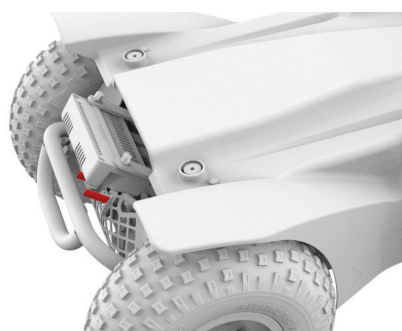
Figur 4.6a - Extreme X8 bremsespaker aktivert
