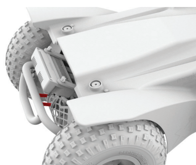
Figur 4.6b - Extreme X8 bremsespaker deaktivert
