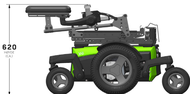
Figur 4.3b - Magic 360 sammenlagt høyde
