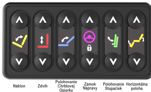
Obrázok 4.12 Typické nastavenie aktivátora jednorazového kliknutia V2
