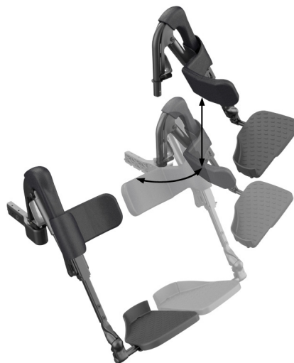
Slika 4.2c Prikazana odstranitev odmičnih naslonov za noge
