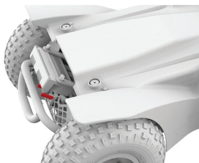
Slika 4.6a Aktivirane zavorne ročice Extreme X8
