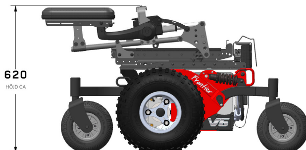
Figur 4.3c Frontier V6 och V4 höjd hopfälld
