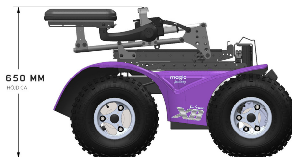
Figur 4.3d Extrem X8 höjd hopfälld
