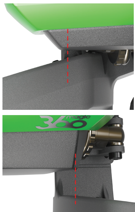
Figura 4.7 - Regulação do amortecedor
