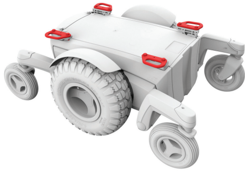
Figura 5.2a Pontos de elevação da Magic 360
