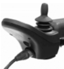
Figura 6.2 - Tomada de carregamento
