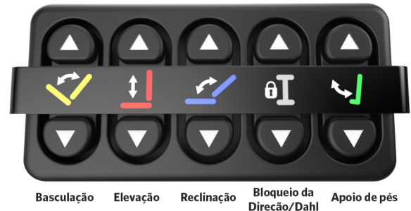
Figura 4.10 Uma configuração típica do activador de um clique
