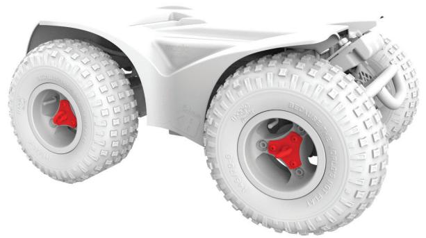
Rys. 5.2d Extreme X8 – punkty do podnoszenia (sprzedawane osobno)
