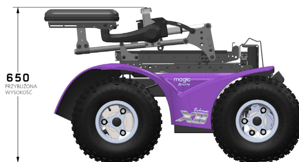
Rys. 4.3d Wysokość całkowita Xtreme X8 po złożeniu oparcia do przodu
