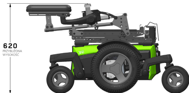
Rys. 4.3b Wysokość całkowita Magic 360 po złożeniu oparcia do przodu
