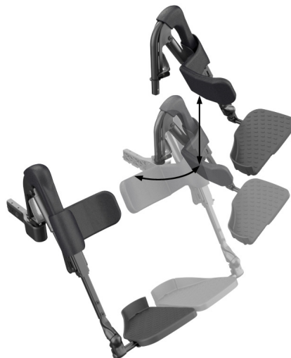
Rys. 4.2c Zdejmowanie odchylanego podnóżka
