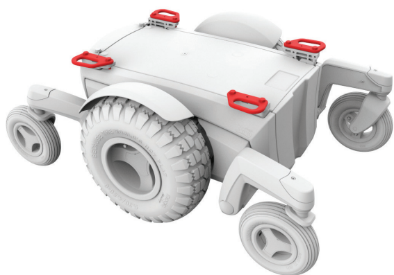
図 5.2a マジック 360 吊り上げ位置
