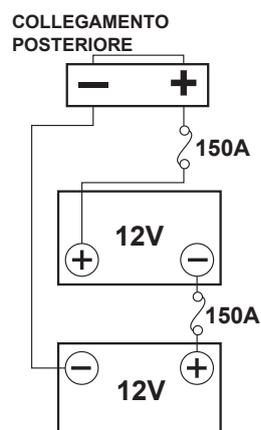
Figura 6.1a - Cablaggio della batteria della carrozzina Magic 360
