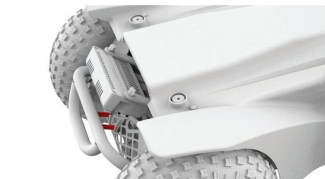
Figura 4.6b Leve del freno di Extreme X8 disinnestate
