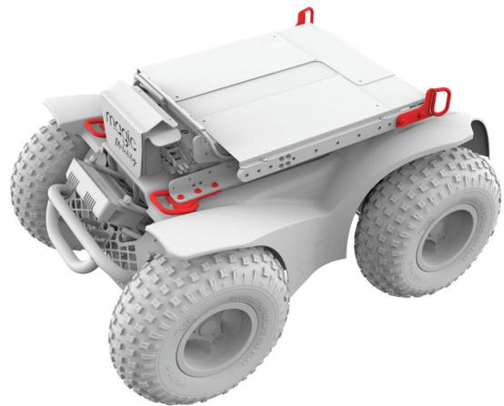
Figura 5.4d Anelli di ancoraggio della carrozzina Extreme X8
