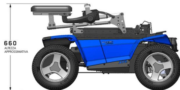
Figura 4.3e Altezza totale di XT2 con schienale abbattuto in avanti
