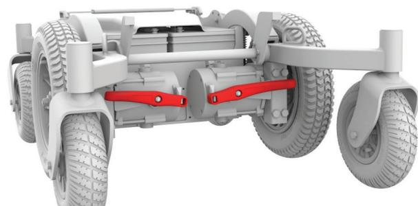
Figura 4.5a Leve del freno di Frontier V6 innestate
