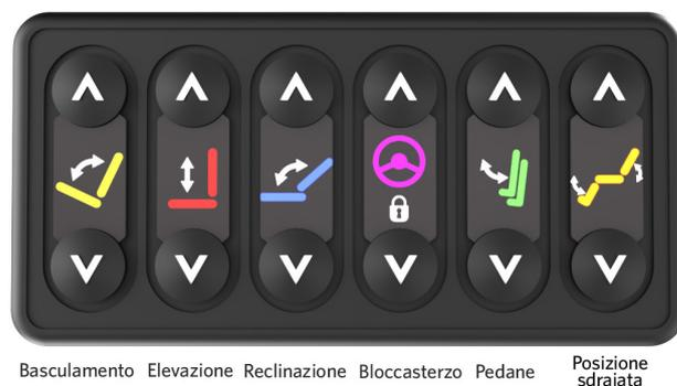
Figura 4.12 Configurazione tipica dell'attivatore One Click V2
