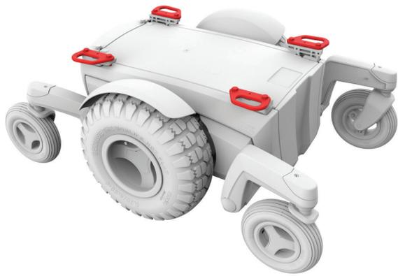
Figura 5.4a Anelli di ancoraggio della carrozzina Magic 360
