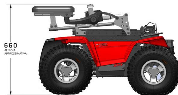
Figura 4.3f Altezza totale di XT4 con schienale abbattuto in avanti
