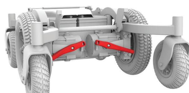
Figura 4.5b Leve del freno di Frontier V6 disinnestate
