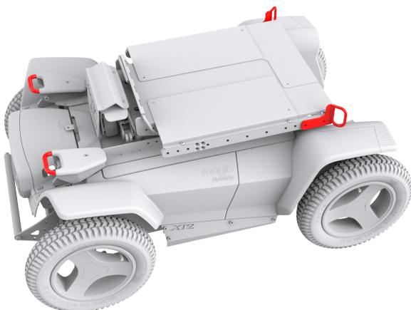
Figura 5.4e Anelli di ancoraggio della carrozzina XT2
