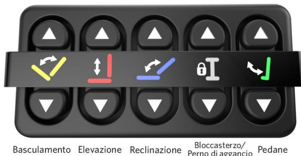
Figura 4.11 Configurazione tipica dell'attivatore One Click V1
