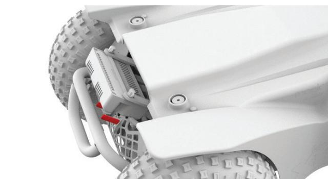
Figura 4.6a Leve del freno di Extreme X8 innestate
