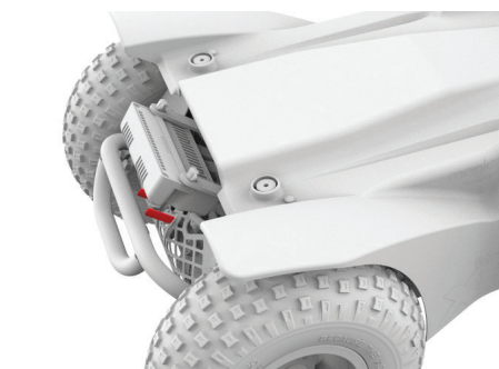
Εικόνα 4.6α Ενεργοποιημένοι μοχλοί φρένων στο Extreme X8
