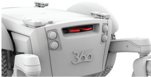
Εικόνα 4.4α Ενεργοποιημένοι μοχλοί φρένων για το Magic 360
