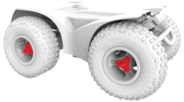
Figure 5.2d Points de levage du l'Extreme X8 (kit vendu séparément)
