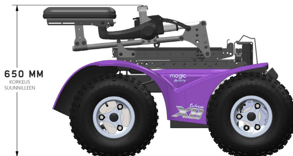
Kuva 4.3d Extreme X8 eteenpäin taiton korkeus
