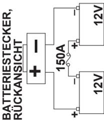
Figure 6.1b – Batterieschaltung Frontier V4, V6 und Extreme X8
