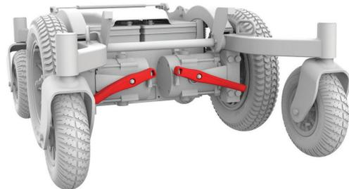
Figure 4.5b Bremshebel des Frontier V6 – gelöst
