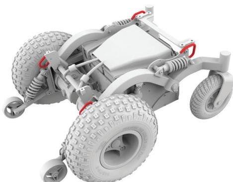
Figure 5.2c Hebepunkte am Frontier V4
