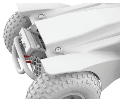
Figure 4.6b Bremshebel des Extreme X8 – gelöst
