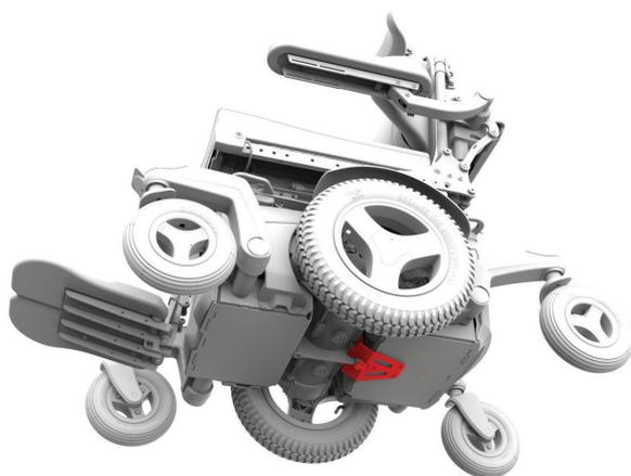
Figure 5.7a Andockbolzen am Magic 360 - eingefahren
