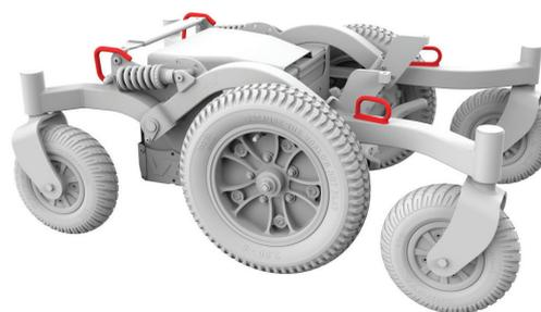
Figure 5.2b Hebepunkte am Frontier V6
