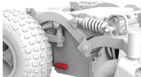
Figure 4.5d Bremshebel des Frontier V4 – gelöst
