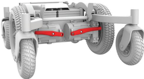
Figure 4.5a Bremshebel des Frontier V6 – betätigt
