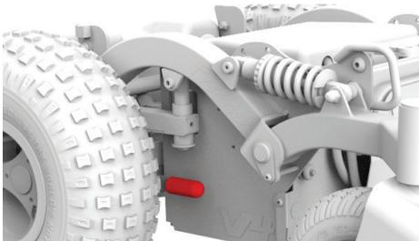
Figure 4.5c Bremshebel des Frontier V4 – betätigt
