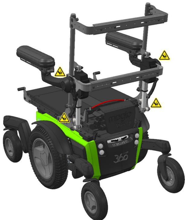
Figure 4.3a Roter Entriegelungsgriff für das Abklappen nach vorne
