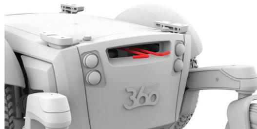
Figure 4.4b Bremshebel des Magic 360 – gelöst
