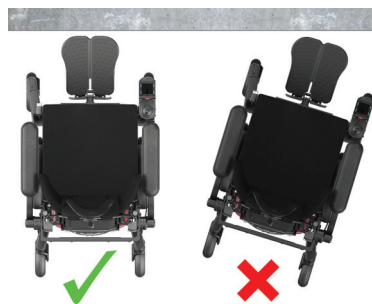
Obrázek 3.1 – Příjezd k překážce
